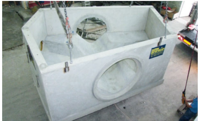
Zulaufbauwerk in Wasserburg
