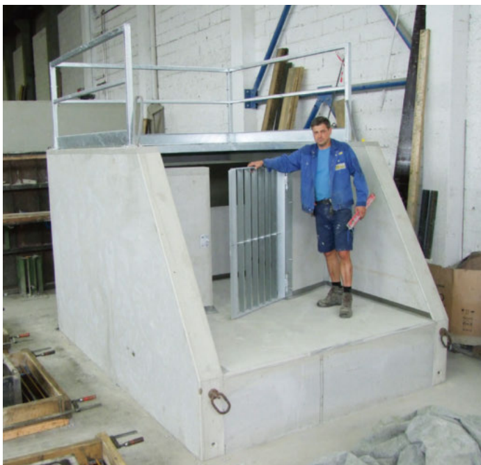
mit schwenkbarem Einlaufgitter
