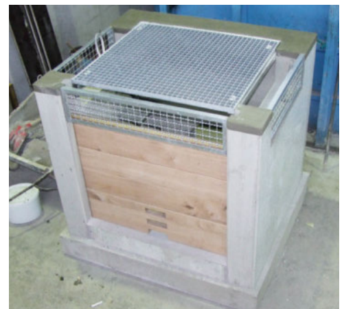
mit 3-seitigem Notüberlauf und Treibgutschutz durch Wellengitter
