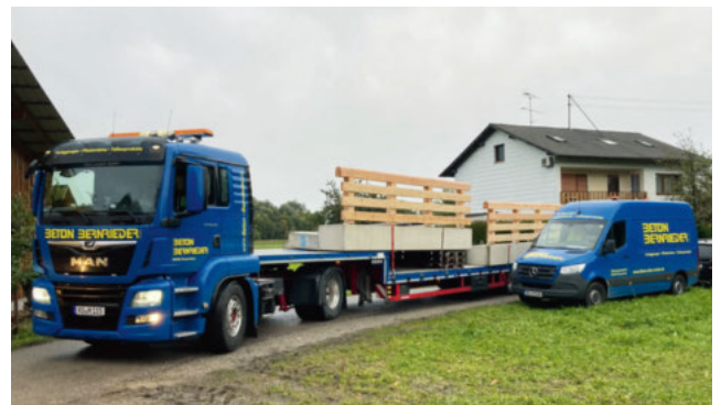
die 2-teilige Ausführung reduziert die Transportbreite
